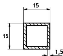
Tubo con sezione 15 x 15 mm
